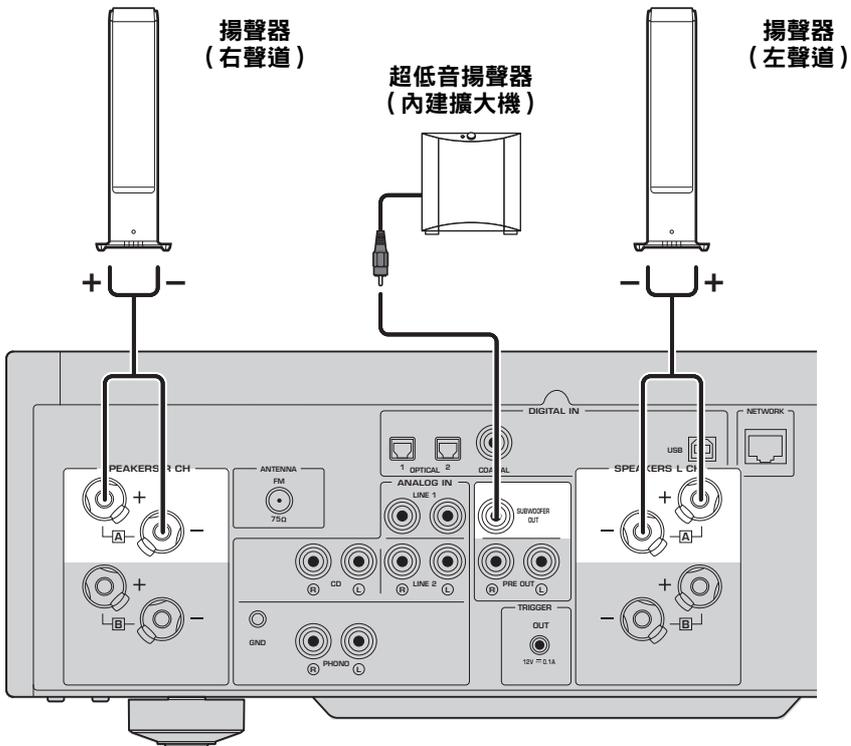
**1** 從揚聲器纜線的末端剝下約 10 mm 的絕緣層，然後將芯線捻緊。
