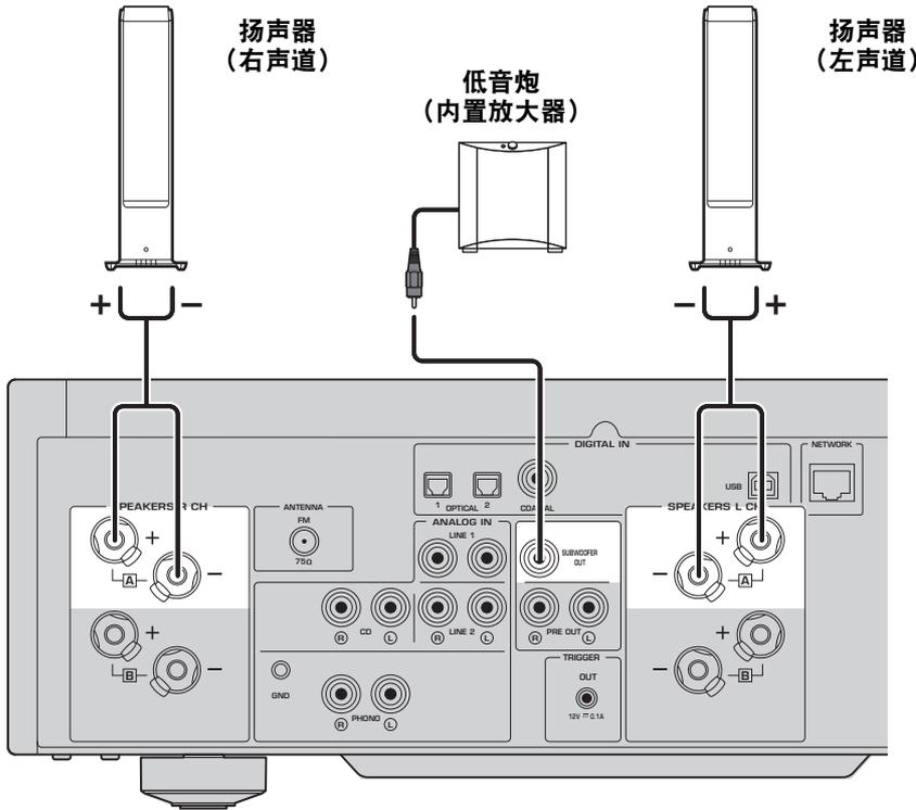
1 从音箱缆线端部剥去大约 10 mm 的绝缘皮，然后拧紧芯线。
