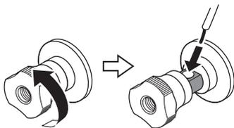
音箱缆线插入孔径：6.0 mm
