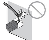
본 기기를 켤 때 "Check SP Wires" 가 전면 표시화면에 표시되면 기기를 끈 다음 스피커 케이블이 단락되지 않았는지 확인하십시오.
